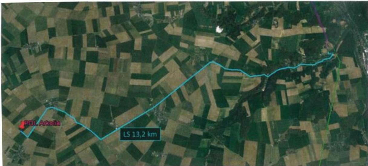
Figure 53. Hypothèse privilégiée de raccordement au réseau électrique
